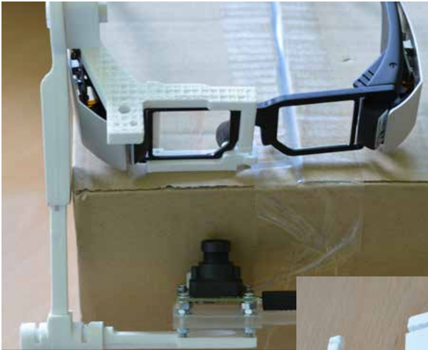
Maßgefertigte Halterung für ein HMD-Brille aus ABS
